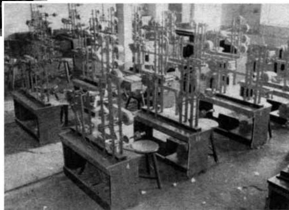
Unsere Bilder zeigen Ausschnitte aus der Fabrikation von Störschutzkondensatoren in den Betrieben der Fa. L. Flörshcim, München. Wir sehen die Wickelei, die Stapel der gepreßten Kondensatoren, fertig zum Einhängen in das Paraffinbad und ganz oben einen Vielfachblock mit den zahlreichen Kondensator-Wickeln im Innern u. der verwickelten Schaltung.
