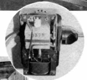
Oben: Abb. 10 und 11 zeigen eine Glätteein- richtung für Störungen durch pulsierenden Gleichstrom in Netz- empfängern.
